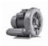
El motor está protegido con una pastilla térmica. Alimentación monofásica: 230V 50hz. Potencia: 0,4 Kw - 3,1 A. Caudal máximo: 1250 l/min. Presión de vacío: 130 mbar. Nivel sonoro: 62 dB (A).
