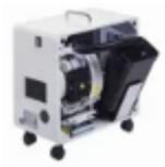
El motor está protegido con una pastilla térmica y para un puesto el mueble se coloca al lado del banco. Además el brazo aspirador y la aspillera deben pedirse a parte.
