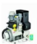
Alcanza 280mbar de presión de vacío con un motor Uni-Jet 75 2V de dos ventolas en serie y separador de amalgama. La presión elevada permite aspirar por tuberías de diámetro reducido, con una presión normal (170-200mbar) sería insuficiente. Potencia rendida: 1,5 kW - 9 A. Caudal máximo: 1.800 l/min.
